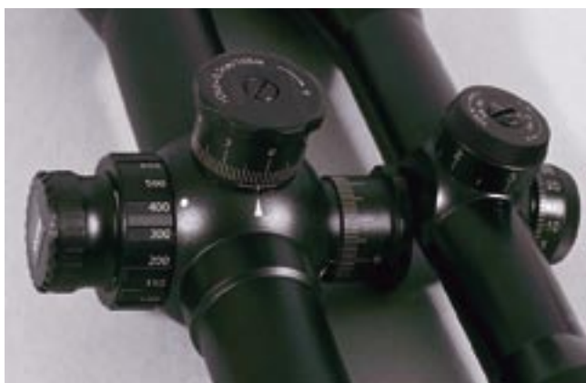
Skillnaden är ganska stor på targetrattarna som 6-24 har till vänster gentemot Hensoldts kulbanekompensator som har metergradering.
