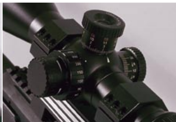
Den vänstra rattan är ljusregleringen som sitter längst till vänster medan den graderade rattan närmast siktet är parallaxjusteringen som nu är inställd på 200 meter.
